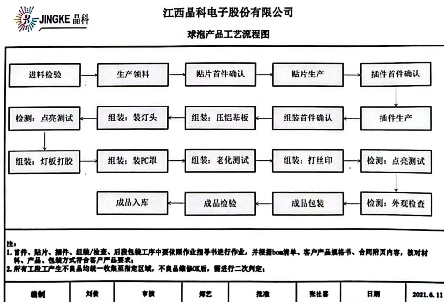
图 3-1 球泡产品工艺流程图
