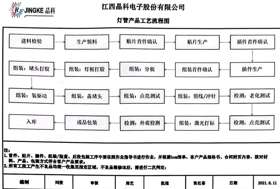
图 3-2 灯管产品工艺流程图
